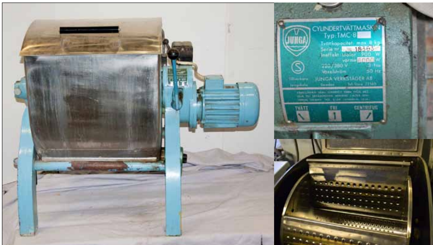
Den första modellen av Junga tvättmaskin, tillverkad i gjutjärn och rostfri plåt. Tvätteffekt 8 kg, värmeeffekt 6 kW, 1 Hk motor, 1400 v/m centrifug. En av de första maskinerna finns att se i vitvaruaffären Bröderna Gustafssons i Åsle. Fotot: från Digitaltmuseum, Peter Häll, Tekniska museet
