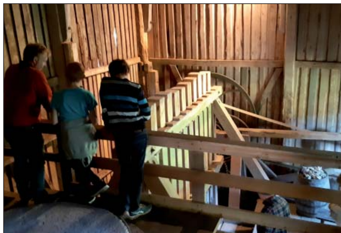
En kraftig axel lyfter lyfter upp stamparna som sedan i tur och ordning faller tungt ner och krossar benen.
