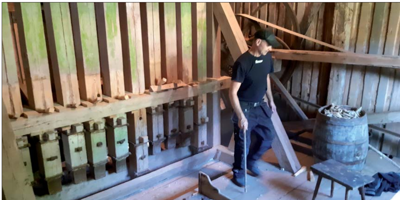
Benstampen med stampar i trä, men med plåtskodda fötter matas för hand som man alltid gjort. I tunnan till höger finns årets ben som skall krossas i benstampen.
