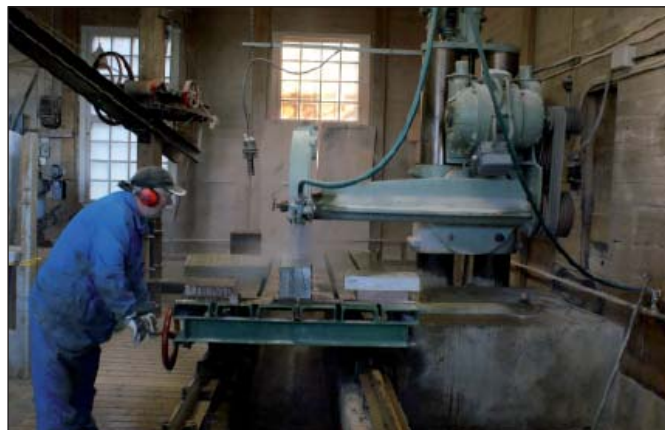
1936 öppnades den nya verkstaden och vissa dagar körs maskinerna så att besökarna får se hur det går till. Vattnet som sprutas i sågen är viktigt för processen.
