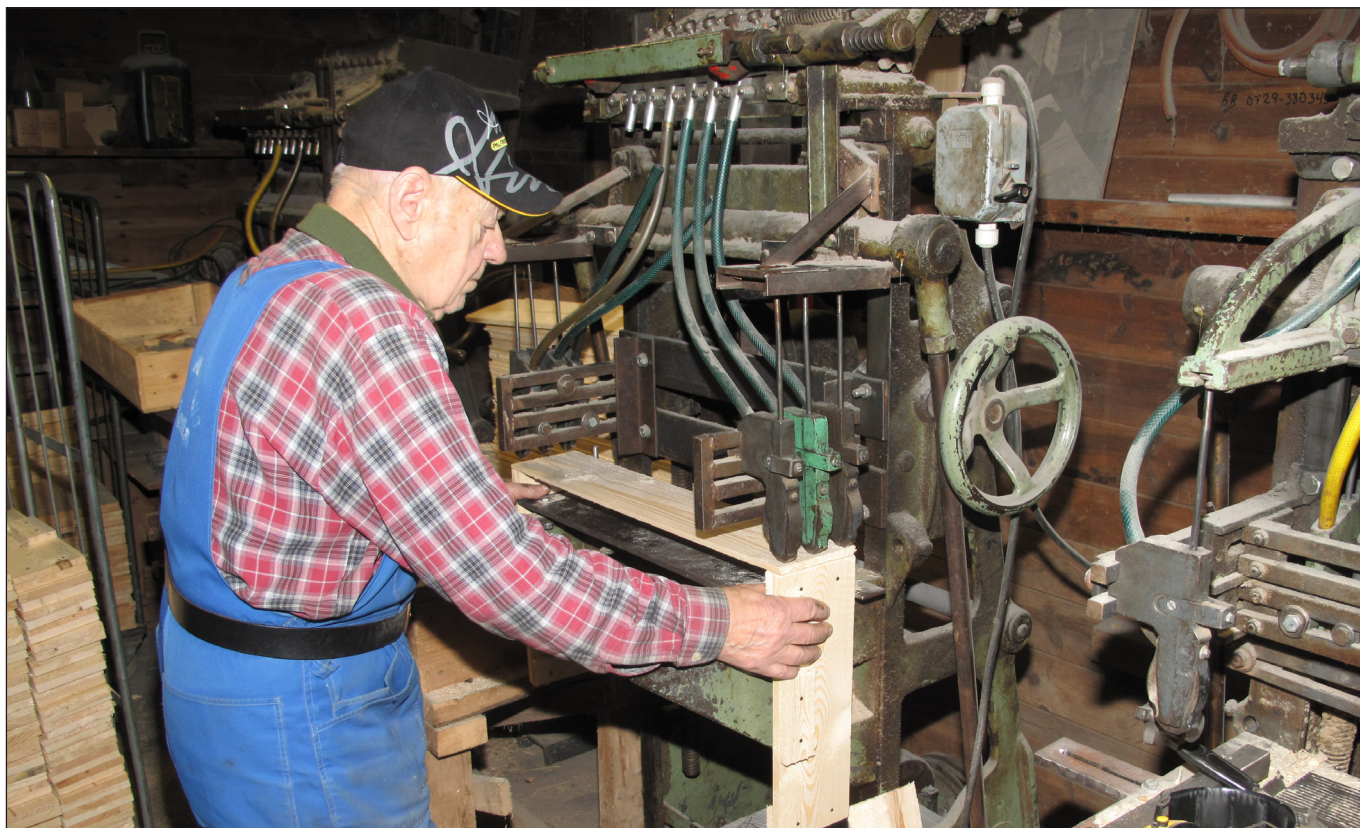
Vid spikmaskinen. Här spikar Olof ihop gavlarna med sidostycken.
