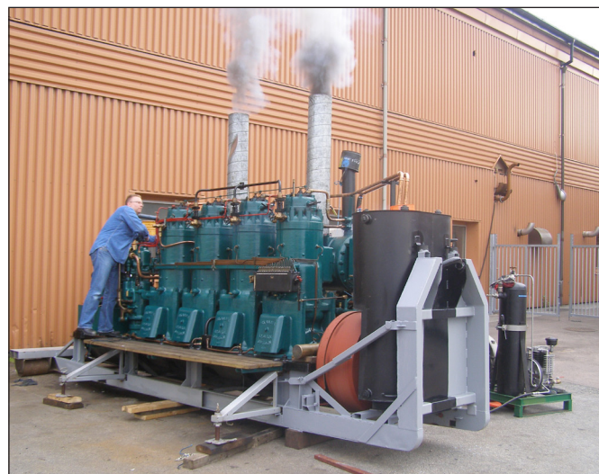
Laurinmedlemmen Martin Johansson startar en fyrcylindrig Skandia tändkulemotor på 300 hk. Motorn väger ca 14 ton och har cylinderdiameter av 320 mm slaglängd 370 mm. Den har tidigare suttit i en bogserbåt i Stockholmsområdet. Motorn identisk med motorn i HARRY.
